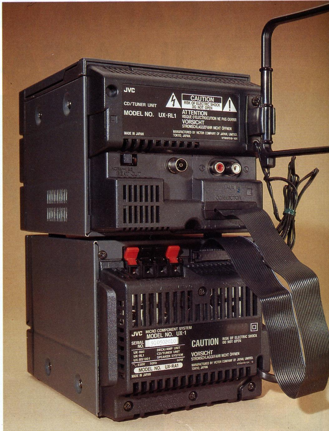
I due blocchi che compongono il micro-sistema JVC UX-1 sono collegati da una larga piattina multifilo. In alto a destra è notevole l'antenna a quadro AM.
